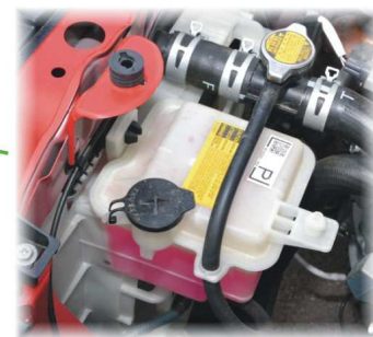
ZBIORNIK WYRÓWNAWCZY PŁYNU CHŁODZĄCEGO
