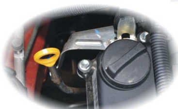
WSKAŹNIK PRĘTOWY POZIOMU OLEJU WLEW OLEJU DO SILNIKA
