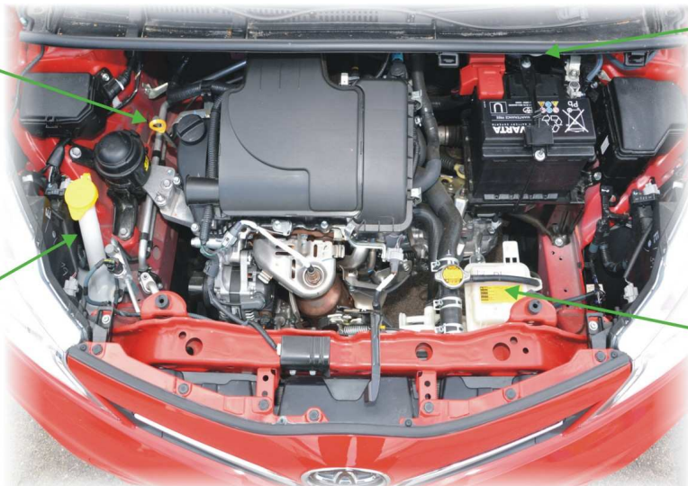
WSKAŹNIK PRĘTOWY POZIOMU OLEJU WLEW OLEJU DO SILNIKA
